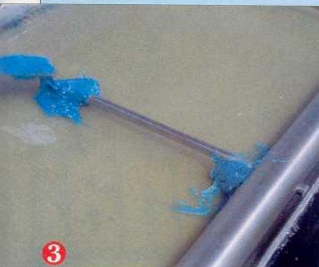
**3** Une choucroute de résine polyester préchargée est préparée avec un durcisseur : cela permet d'obtenir une pâte consistante qui va prendre par paquets et permettre d'assembler les tiges à la forme moulée. Cette choucroute, bleue au départ, devient grise au fur et à mesure de son séchage.
