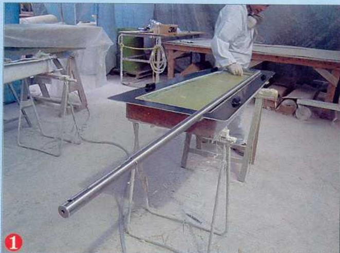
**1** Les pourtours de la pièce moulée, encore dans le moule, sont nettoyés avant le début des opérations avec une cire de démoulage qui empêchera la résine d'y rester collée. La tige inox est calée dans les inters prévus à cet effet.
