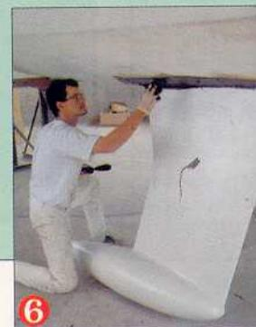
Reste à retirer, avant qu'il ne soit sec, l'excédent de mastic et à lisser le pourtour de la jonction quille/coque pour une finition propre.
