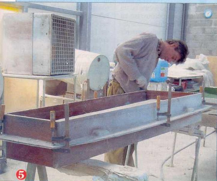
**5** L'autre moule vient s'emboîter dessus, avant que la colle polyester ne sèche, pour former un bloc. Après avoir refermé le moule en assurant une pression régulière à l'aide de six serre-joints, on laisse reposer 48 heures avant le démoulage, un temps largement suffisant pour que l'assemblage soit parfaitement sec. On injecte ensuite de la mousse expansée qui participe à la bonne tenue du profil.
