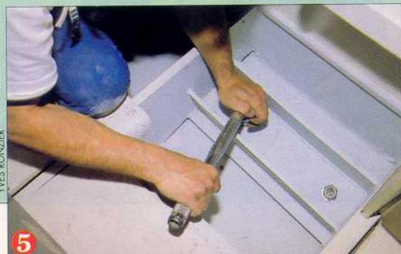
Des tiges filetées sont prises dans la quille, bloquées avec du frein filet. On les boulonne à l'intérieur, directement sur la structure métallique avec quatre écrous nylstop. Une fois vissées, elles ne bougent plus.
