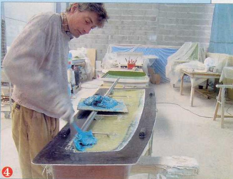
**4** Avec une grande raclette on recommence la même opération le long de la tige de transmission et sur tout le pourtour du moule. Notez que la choucroute déborde généreusement, de manière à assurer une bonne surface d'encollage avec l'autre partie du moule qui va être amenée dessus.
