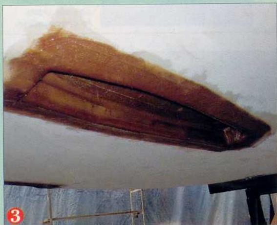
Les deux zones d'assemblage font l'objet d'une préparation spécifique : elles sont recouvertes d'une épaisseur de résine époxy chargée, qui va permettre d'étanchéifier. Au bout de 24 heures, la résine est poncée et cette surface est stratifiée. Trois bi-biais sont superposés, ils dépassent largement l'encoche pour renforcer l'ensemble de la zone de liaison.
