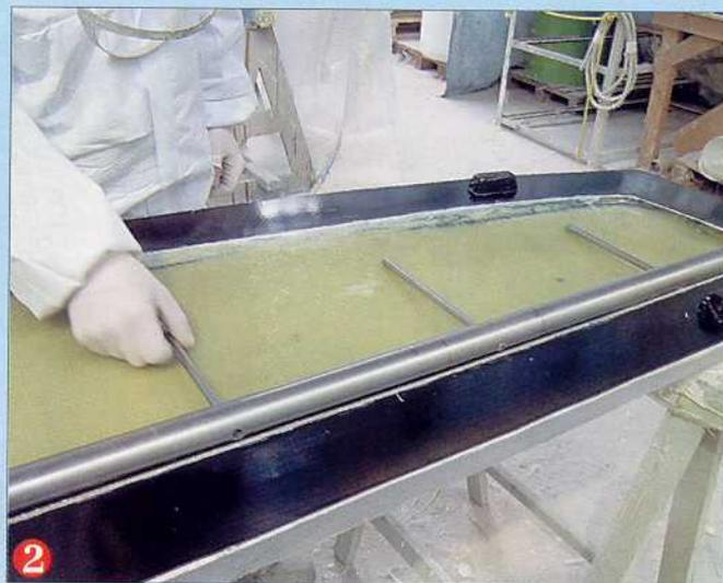
**2** Des barres de renfort transversales sont glissées dans la mèche, de manière à ce que ce ne soit pas celle-ci qui tourne lorsque l'on bouge la barre mais bien l'ensemble du safran. Une règle permet de vérifier leur alignement.
