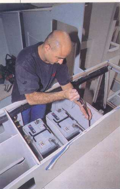
Les batteries doivent être solidement fixées mais rester facilement accessibles.
