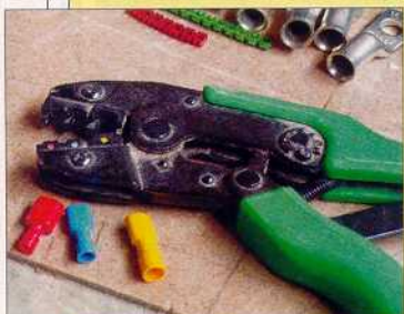
Un code couleur facilite l'utilisation de la pince.
