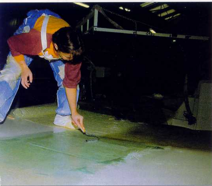
Le pinceau est utilisé pour s'assurer de la présence de résine dans les angles, comme ici au niveau du livet de pont.
