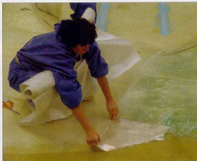
Si les grandes surfaces sont préparées sur la table de découpe, les petites pièces sont découpées à même le moule.
