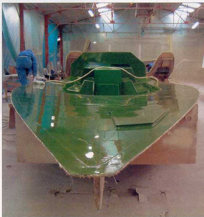
Avant la projection du gel-coat, le moule doit être impeccablement ciré pour assurer un démoulage facile et une finition parfaite.
