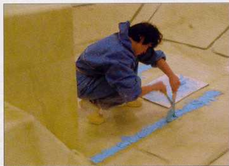
Les reliefs en creux, ici les rails du capot de descente sont remplis à l'aide d'une choucroute, une résine polyester préchargée avec de la fibre de verre.
