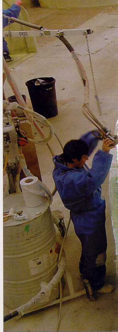
Les reliefs en creux, ici les rails du capot de descente sont remplis à l'aide d'une choucroute, une résine polyester préchargée avec de la fibre de verre.
