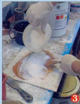
On ajoute de la silice. Selon l'usage, on peut aussi ajouter des microbilles ou de la poudre de bois pulvérisé, qui accélèrent et augmentent plus ou moins la dureté du matériau.
