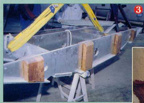
Deux pièces en stratifié sont boulonnées sous les parties planes de la structure. Celles-ci sont appelées « coquilles » dans le jargon de Fora : ce sont elles qui vont accueillir les têtes de quille.
