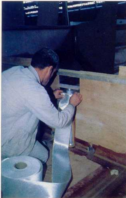
La jaumière, fixée sur la coque, est aussi stratifiée sur la cloison arrière.
