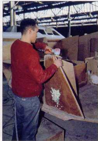
Le fond de la baille à mouillage est stratifié avant d'être posé.
