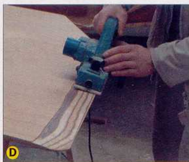
Le fond qui vient s'appuyer sur la jupe est chanfreiné à l'aide d'un rabot électrique pour obtenir la plus grande surface de collage.
