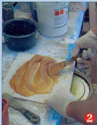
Il faut mélanger longuement pour obtenir une pâte homogène. Le support sur lequel on réalise le mélange est utilisé pour emporter la matière jusqu'à son application.
