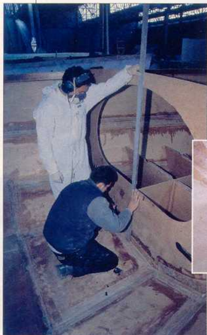
Depuis les repères tracés dans l'axe du bateau, jusqu'aux cales provisoirement vissées sur le bordé, l'équerrage est essentiel dans cette étape.
