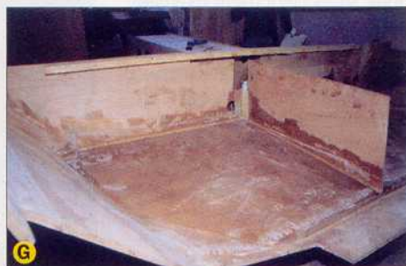
Une colle réalisée avec de l'époxy chargée est appliquée sur toutes les surfaces de repos.
