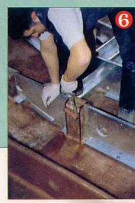
La structure métallique est apportée dans la coque et l'on détermine son positionnement grâce à trois gabarits en CP. C'est elle qui va décider du bon équilibre du bateau.
