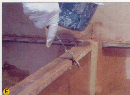
Une colle réalisée avec de l'époxy chargée est appliquée sur toutes les surfaces de repos.
