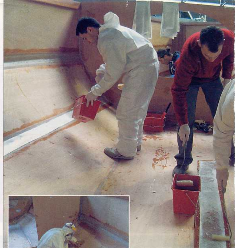
Après 24 heures de séchage, toutes les bandes de stratification sont légèrement poncées.
