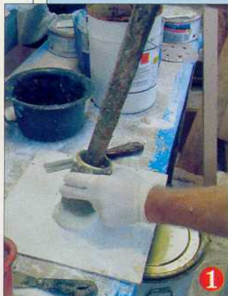
Un doseur est utilisé pour la résine et un autre pour le durcisseur. Les produits sont déposés à l'aide d'une sorte de pilon.
