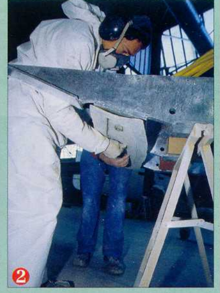
On ajoute sur la structure des pièces en ajout collées à la PPU. Ces dernières permettent d'arrondir les angles à l'endroit où une stratification en cavalier de la structure sur la coque va être faite.
