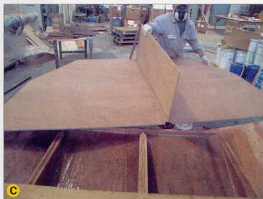
La pièce qui forme le fond des coffres de la jupe est positionnée une première fois pour vérifier son bon ajustement.
