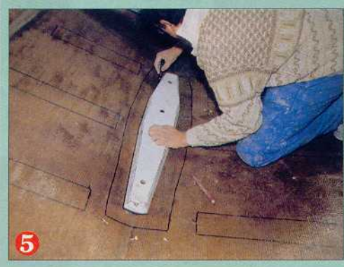
5 Une fois positionnée au millimètre, on trace la forme au marqueur puis on l'enlève pour préparer le fond du bateau. Un gabarit permet de tracer la découpe correspondant à la tête de quille.
