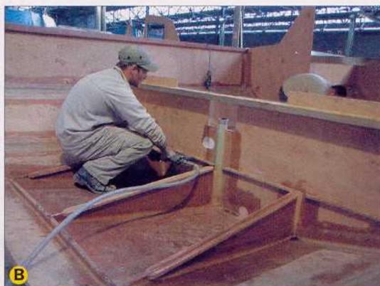
Des tasseaux sont ajoutés à l'arête supérieure des équerres ainsi qu'au fond de la jupe et sur la cloison arrière. Ils sont agrafés et collés.
