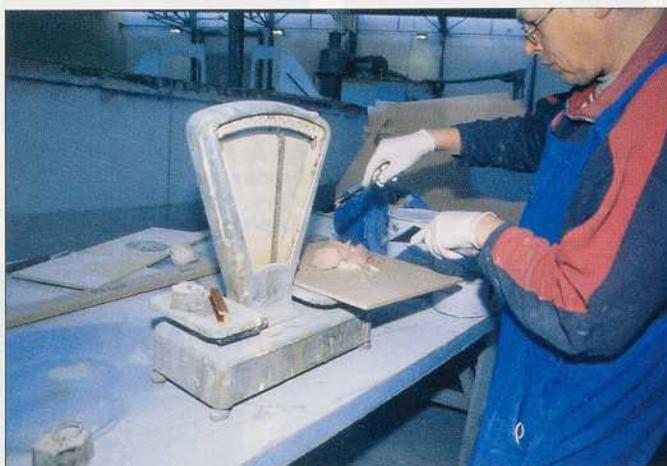
**On utilise une balance pour effectuer le dosage des composants de l'enduit avec un maximum de précision.**
