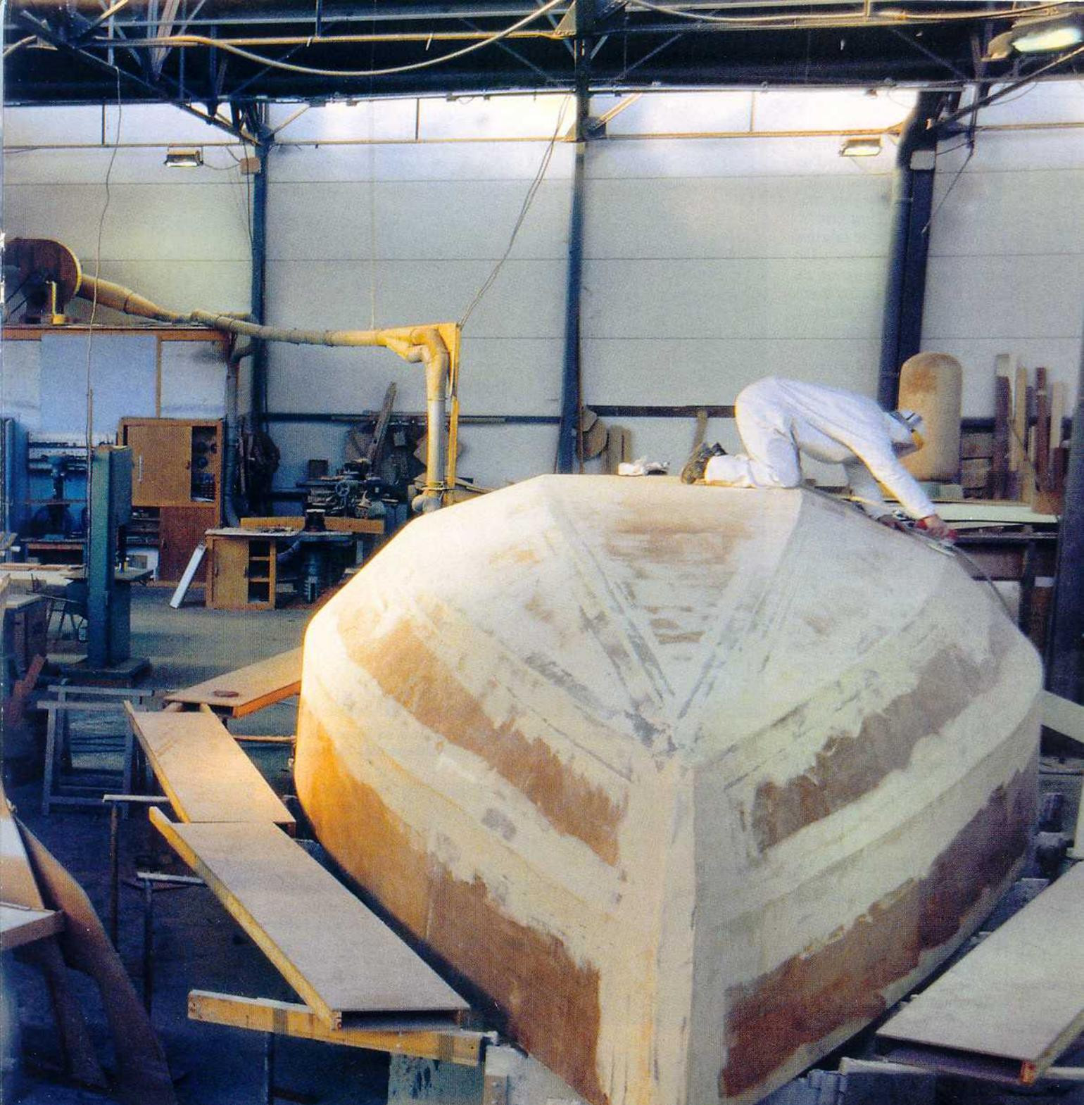
*C'est la phase la plus spectaculaire de la construction. En quelques semaines, de la préparation de la pose des bordés au retournement, nous voyons apparaître la coque dont l'aspect général ne changera pratiquement plus jusqu'à la mise à l'eau.*
