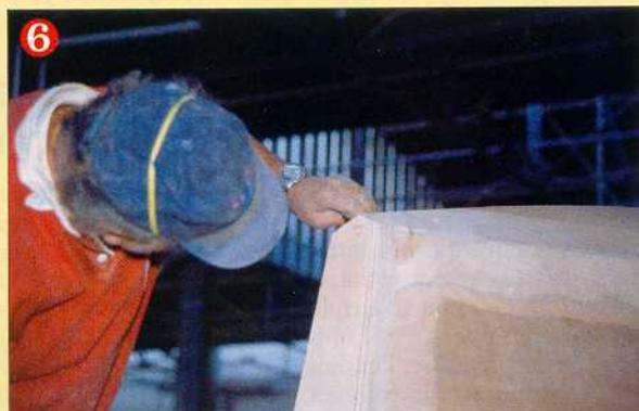
Avant le passage de l'enduit puis de l'apprêt, la nouvelle étrave doit être parfaitement alignée avec les bordés.
