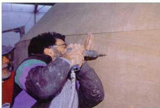
Les bordés sont provisoirement maintenus grâce à des vis qui traversent le contreplaqué (à gauche) et se prennent dans des cales de bois fixées sur les couples qui forment le gabarit (à droite).
