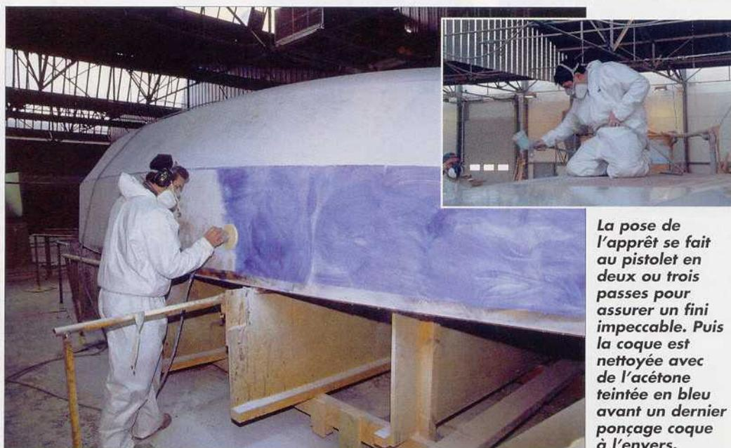
La pose de l'apprêt se fait au pistolet en deux ou trois passes pour assurer un fini impeccable. Puis la coque est nettoyée avec de l'acétone teintée en bleu avant un dernier ponçage coque à l'envers.
